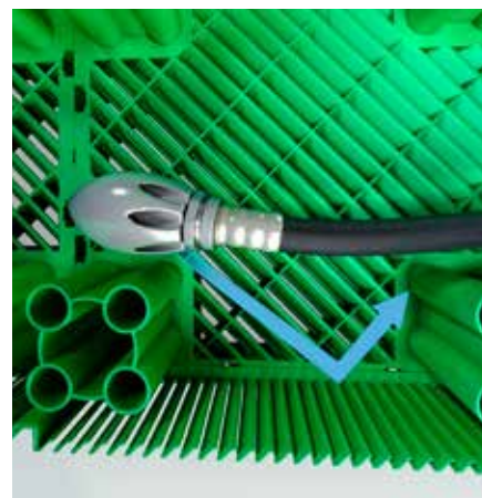
Innovatieve constructie van zijpanelen en bodemplaten. Schuine ribben draaien tijdens het reinigen de drukwaterstraal terug en voorkomen zo schade aan het geotextiel.
