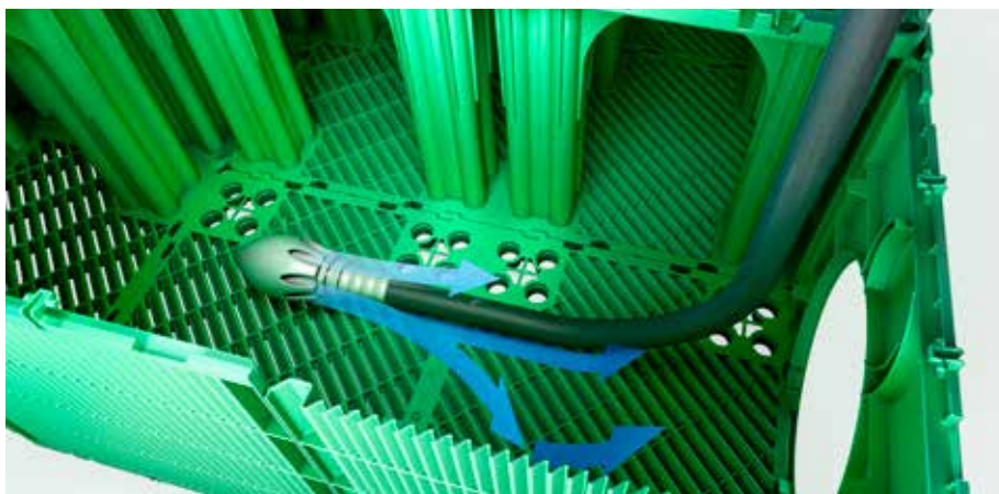
Innovatieve constructie van zijpanelen en bodemplaten. Schuine ribben draaien tijdens het reinigen de drukwaterstraal terug en voorkomen zo schade aan het geotextiel.
