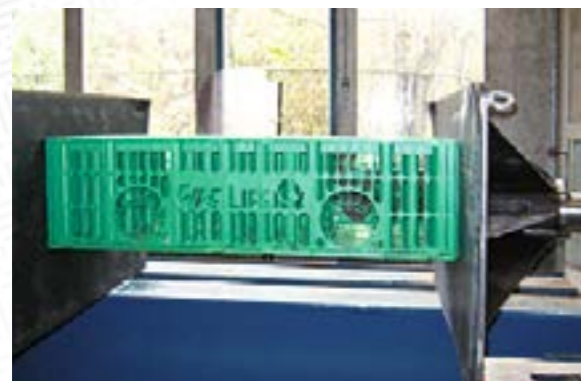
Belastingstest van de Infiltratie Box
